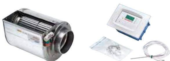
Ventilador eléctrico centrífugo (80W) con centralita electrónica empotrable con regulación automática o manual de la ventilación. La pantalla digital muestra la temperatura del aire; en la modalidad automática modula la velocidad del ventilador en función de la temperatura de la chimenea siendo posible canalizar el aire caliente hacia otras habitaciones.
