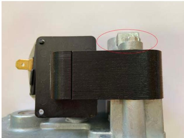
3. Cambiar la bobina (núcleo magnético) de posición, la parte de abajo pasa arriba y la de arriba pasa abajo, algo así como si le dices la vuelta a una chuleta.
