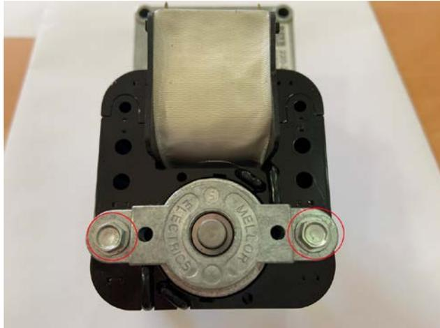
2. Una vez vez aflojados, desenroscar y sacar completamente los dos tornillos, ahora se podrá quitar el soporte que sujeta la bobina contra el reductor.
