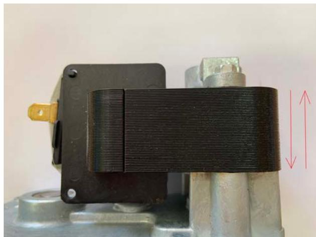
4. Volver a colocar el soporte en su posición y apretar nuevamente los tornillos, ahora el motorreductor girará en sentido contrario.
